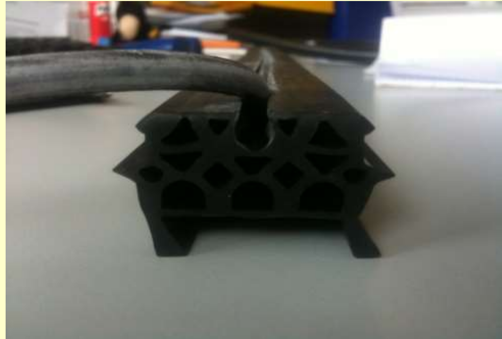
Joint de voussoirs ancré mixte (compressible + hydroexpansif)
