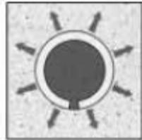
Boulon à ancrage par compression
