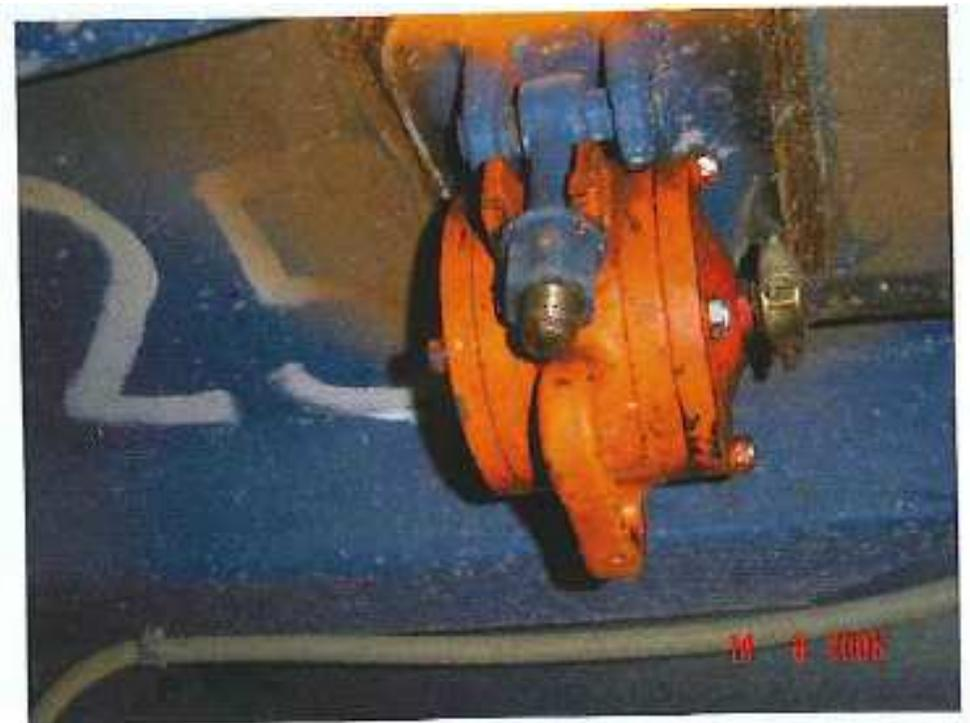
Figure 34 - Vibrateur à air comprimé sur coffrage
