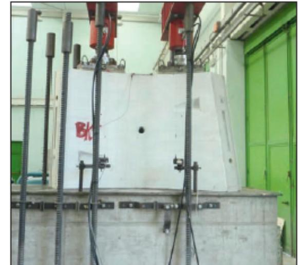
*Essai de pression localisée (simulant l'action des vérins de poussée du tunnelier) sur un voussoir prototype à l'échelle 1. (Université de Rome)*
